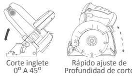
Corte inglete 0° A 45°    Rápido ajuste de Profundidad de corte
