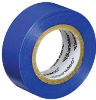
CINTA DE AISLAR AZUL / 19MM X 18M / ESPESOR 0.15 MM ADHESIVO ACRÍLICO / RETARDANTE AL FUEGO
