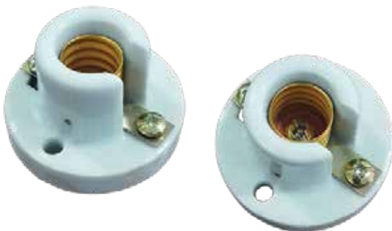
SOCKET PORCELANA BLANCO / ENTRADA 7 1/2" CASQUILLO ATORNILLADO LATONADO BASE E-12, 127V~660W
