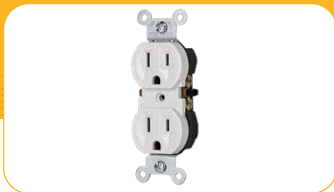
CONTACTO DUPLEX USO DOMÉSTICO BLANCO MATERIAL BAQUELITA CAPACIDAD 127V, 15A CONTACTO DUPLEX POLARIZADO ATERRIZADO
