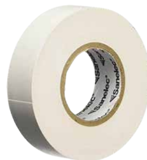
CINTA DE AISLAR BLANCA / 19MM X 18M / ESPESOR 0.15 MM ADHESIVO ACRÍLICO / RETARDANTE AL FUEGO
