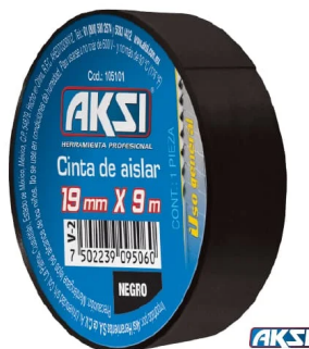
CINTA DE AISLAR NEGRA / 19MM X 9M / ESPESOR 0.18 MM ADHESIVO ACRÍLICO / RETARDANTE AL FUEGO
